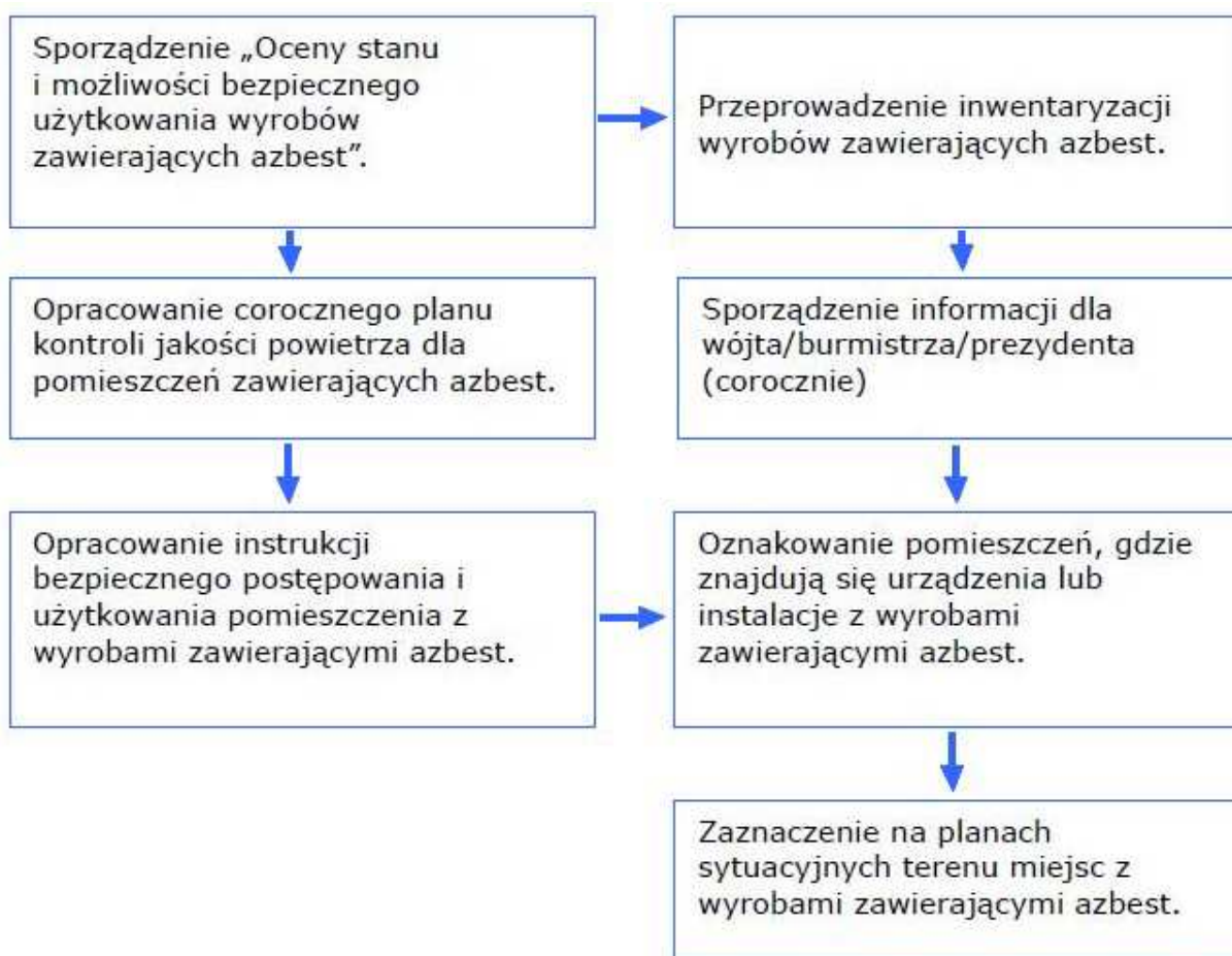
Rysunek 3. Schemat procedury postępowania właścicieli i zarządców przy użytkowaniu obiektów i terenów z wyrobami zawierającymi azbest.
